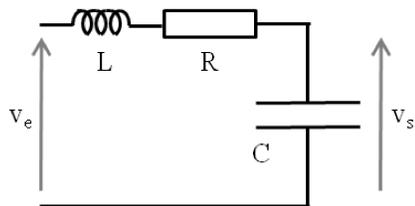
On suppose que la tension en entrée  $V_e = E$  est constante. On suppose que  $V_s(0) = 0$  et  $V_s'(0) = 0$ .
